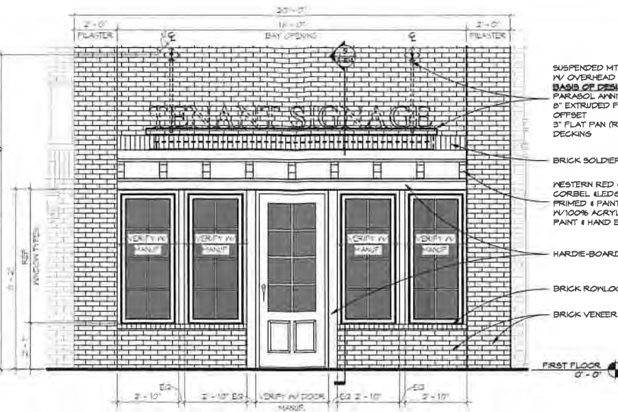
3 STOREFRONT BAY ELEVATION SCALE: 3/8" = 1'-0"
