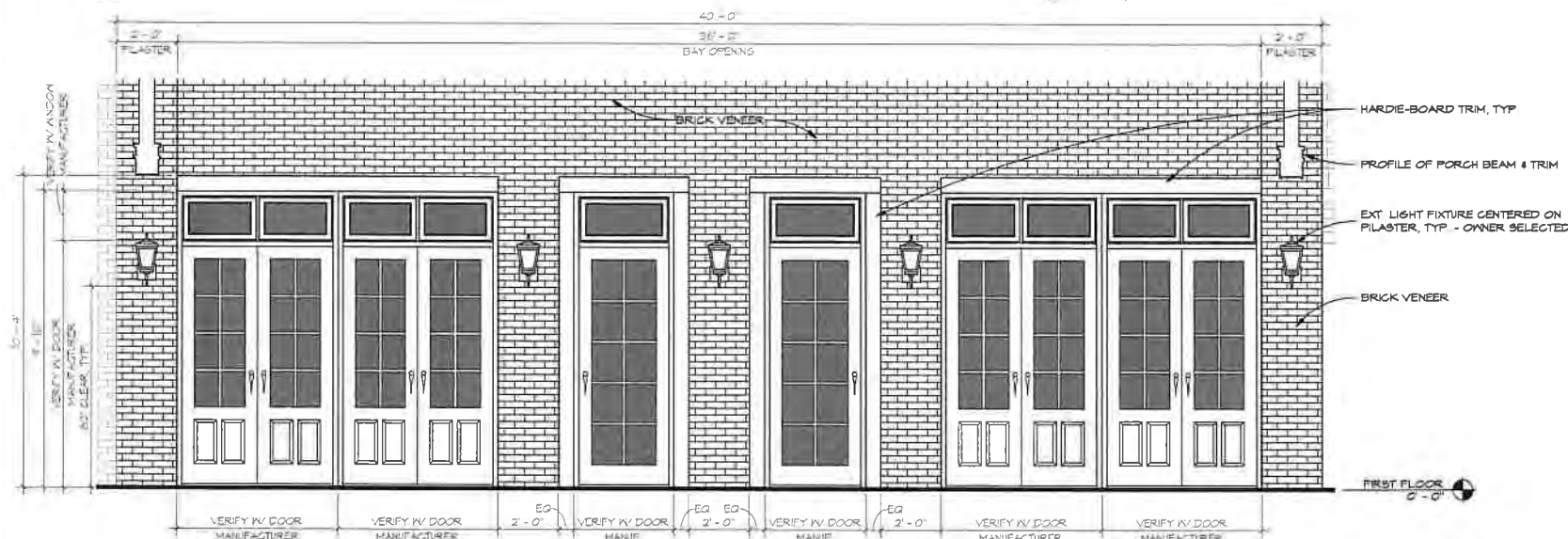
5 STOREFRONT BAY ELEVATION SCALE: 3/8" = 1'-0"
