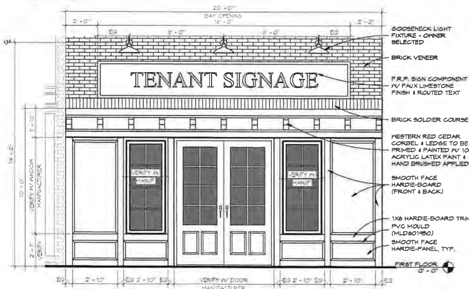
4 STOREFRONT BAY ELEVATION SCALE: 3/8" = 1'-0"
